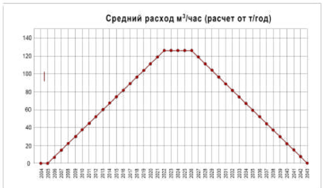
Рисунок 2. График полного цикла сбраживания отходов от полигона ТКО в г. Курганинск, Краснодарского края относительно максимального расхода выделения биогаза м³/час
